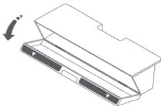
3. Turn the dust bin over and pour out the dust
